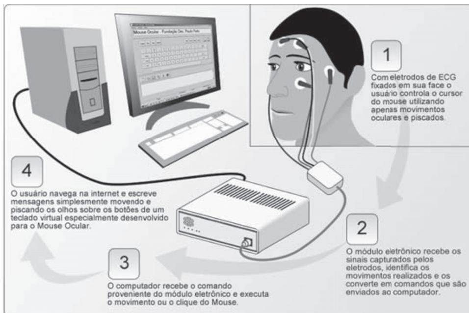
Figura 5. Esquema de funcionamento do *Mouse Ocular* baseado em eletro-oculografia (Cardoso, 2009).
