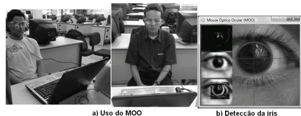
Figura 7. Dispositivo Rastreador construído para testes do TeleEye: (a) Usuários da primeira geração do MOO; e (b) Janela de detecção da íris.
