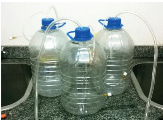
**Figura 1.** Biorreatores de plásticos para a fermentação.
