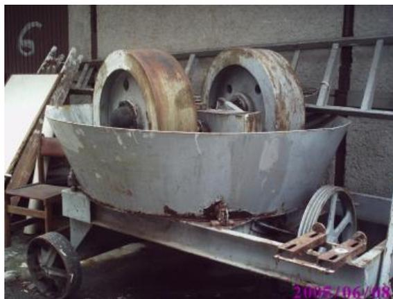
*Figura 8: Equipamento utilizado para a produção de agregado reciclado – moinho de rolos (Fonte: Linhares, 2005).*
