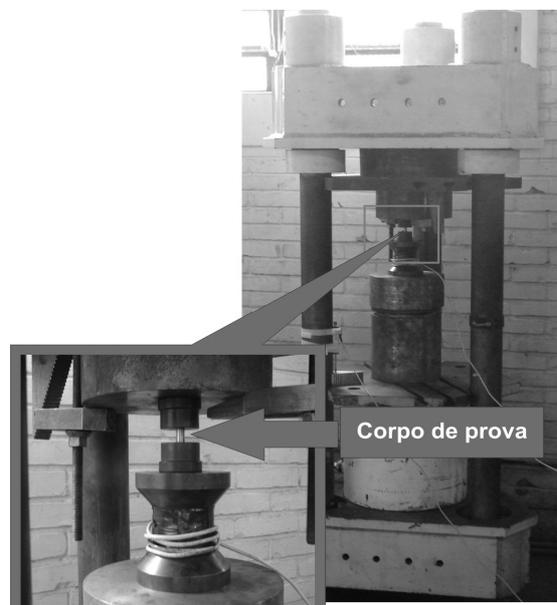
Figura 5. Prensa hidráulica utilizada no ensaio de compressão.
