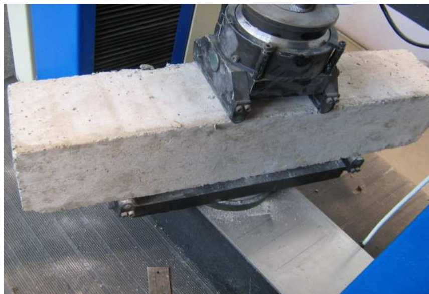
Figura 3: Ensaio de resistência à tração na flexão.
