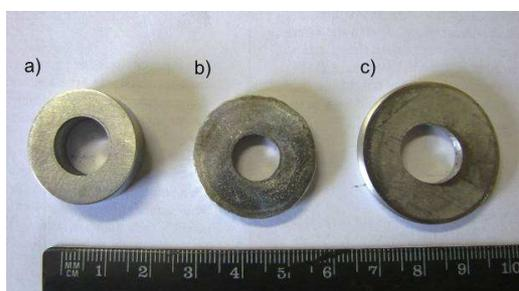
Figura 6: Anéis deformados em ensaio de compressão.
