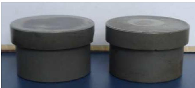
Figura 10: Bases cerâmicas de Zircônia.
