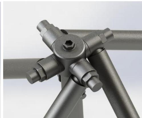
**Figuras 22 a la 25.** Diseño de los detalles en 3D de las uniones de membrana a la estructura.
