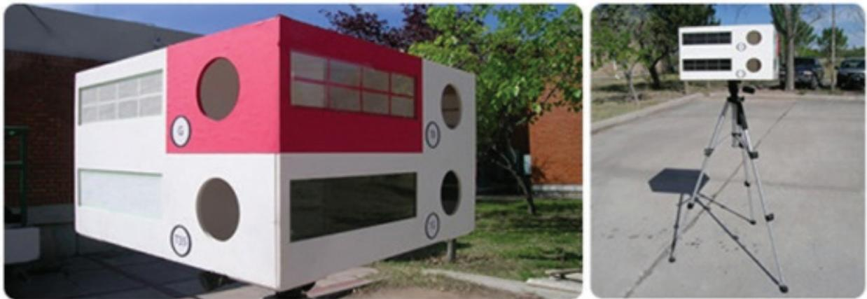
**Figura 4.** Modelo a escala en el cual se efectuaron las mediciones de TCC.
