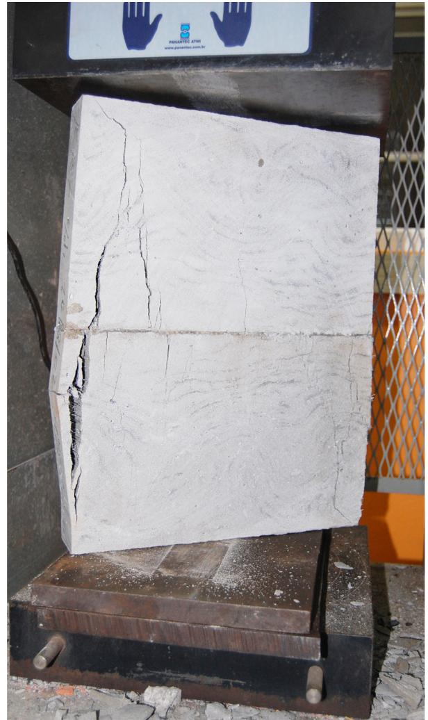
**Figura 14.** Prisma com fibra óptica após a ruptura; não houve perda de fragmentos.
