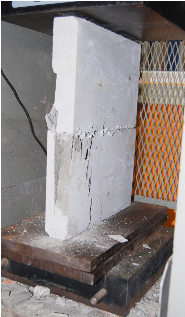
**Figura 13.** Prisma referência após a ruptura; fragmentos dos blocos se soltaram.
