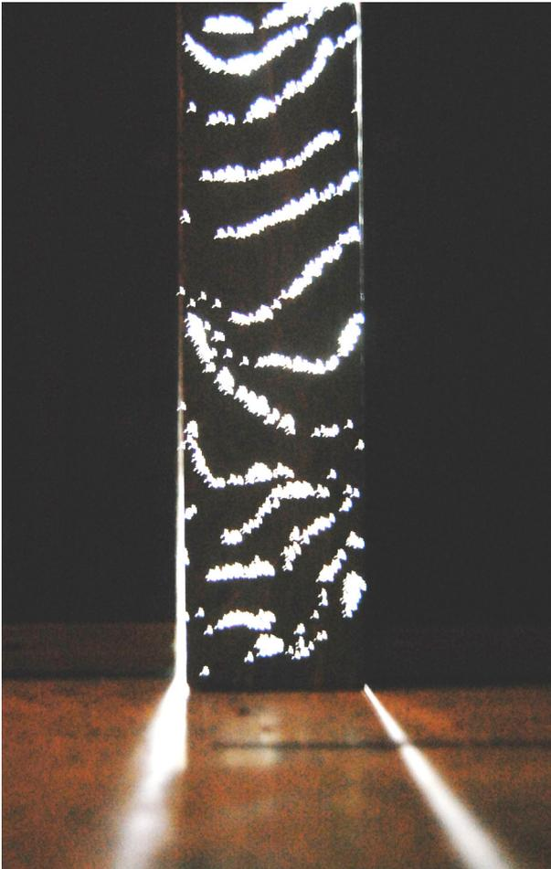
**Figura 4.** Primeiro bloco de concreto translúcido produzido com fibras aleatórias para este artigo.
