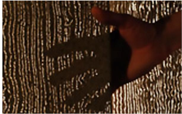
**Figura 1.** Bloco de concreto translúcido produzido pela LiTraCon.
