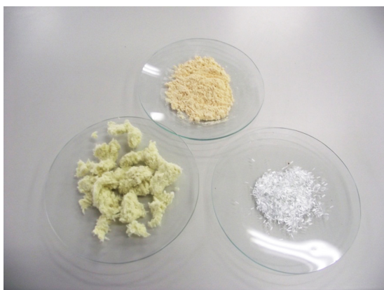
Figura 1. Amostras: resina fenólica (acima), fibra aramida (esquerda) e fibra de vidro (direita).
